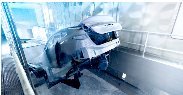
Prozessabschnitt Vorbehandlung der Rohkarossen in der Lackiererei BMW Group Werk Leipzig Abbildung 31
